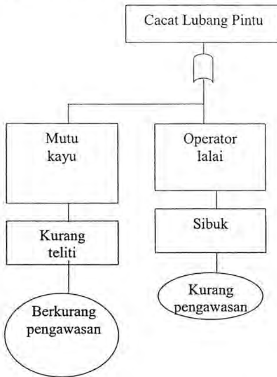
Gambar 5.17. FTA (Fault Tree Analysis ) Cacat Lubang Komponen
