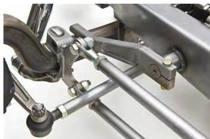
Gambar 2.5. Suspensi Ujung Depan Independen Menggunakan Torsion Bar (*Independent Front End Suspension Using Torsion Bar*)
