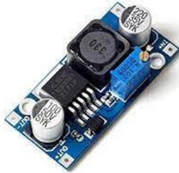
Gambar 2.5. Modul DC Step Down Sumber: zutech.ro/kituri-audioidiverse
