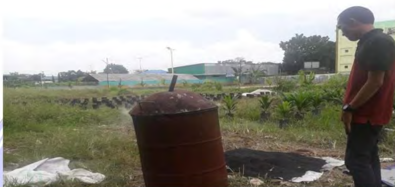
Proses pembuatan biochar gabah kosong dengan menggunakan tabung pirolisis
