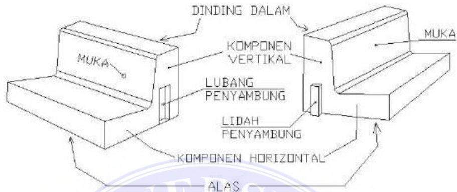
Gambar 1. Komponen dan bagian-bagian kerb (SNI, 2020)
