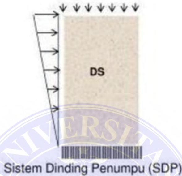
Gambar 2 Sistem Dinding Penumpu Struktur Gedung (SNI-1726:2002)
