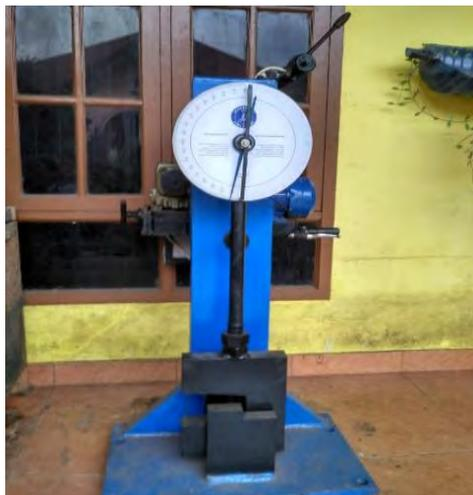
Gambar 3.4. Mesin Uji Impak *Charpy*
