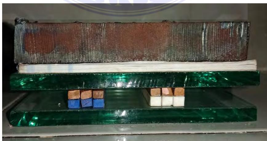
Gambar 3.27. Tampak samping spesimen yang diberi beban plat besi dengan berat 5 kg
