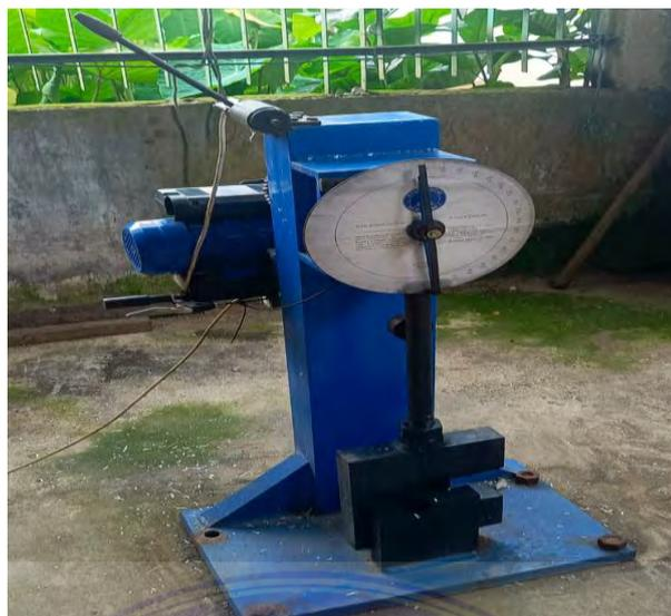
Gambar 3.29. Persiapan alat uji impak *charpy*
