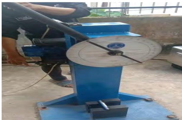
Gambar 3.32. Lengan pendulum dinaikkan
