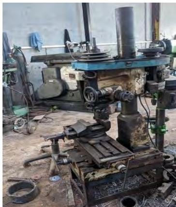
Gambar 3.10. Mesin *milling*
