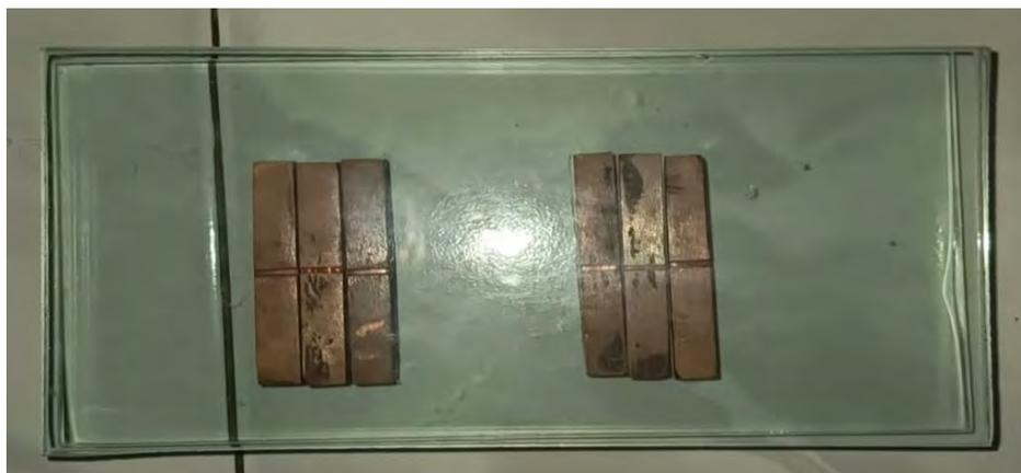
Gambar 3.25. Tampak atas spesimen yang sudah digabung tetapi belum diberi beban plat
