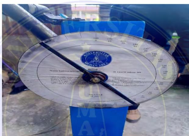
Gambar 3.33. Posisi awal sudut  $147^{\circ}$  sebelum pengujian spesimen
