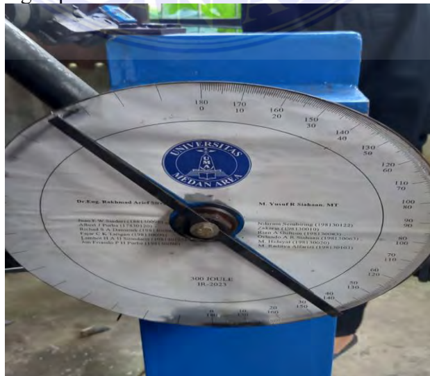
Gambar 3.26. Posisi awal sudut 147^{\circ} sebelum pengujian spesimen
