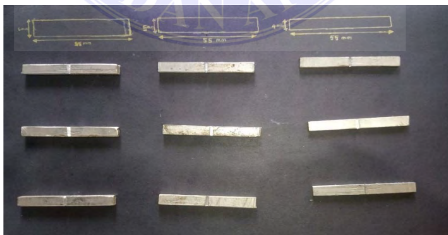
Gambar 3.10. Alumunium setelah dipotong dan diberi takik
