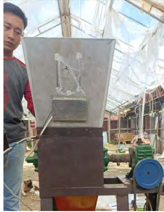
Gambar 3.11. proses pemasangan hooper pada mesin pencacah
