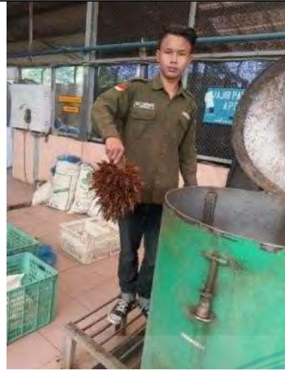
Gambar 17. Merontok Buah Kelapa Sawit dengan Menggunakan Mesin Perontok
