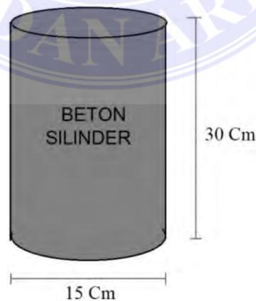
Gambar 8. Pemodelan benda uji
