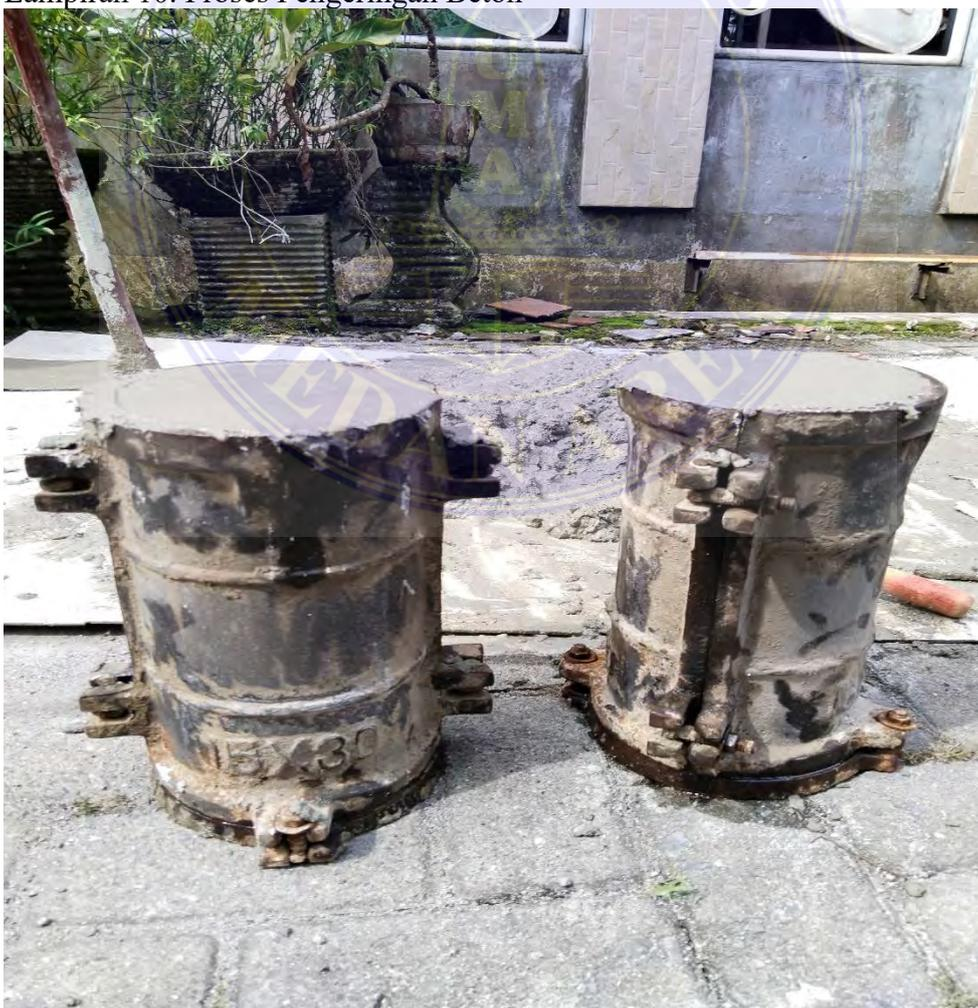
Lampiran 11. Pelepasan Beton Dari Cetakan
