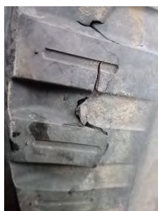
Gambar 2. 6 Ban yang Retak
