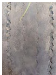
Gambar 2. 4 Ban yang Keausan tidak teratur
