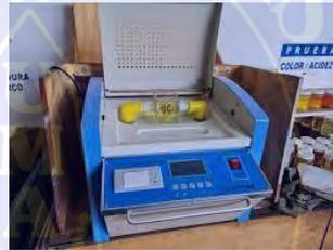
Gambar 3.3 Alat Pengujian BDV
