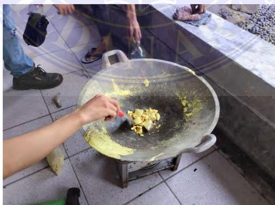
Gambar 21 Pembuatan *capping*
