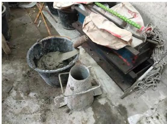
Gambar 19 Kerucut *Abrams*
