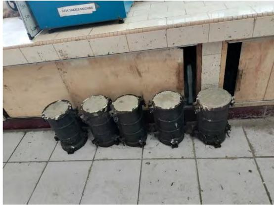
Gambar 16 Cetakan Silinder
