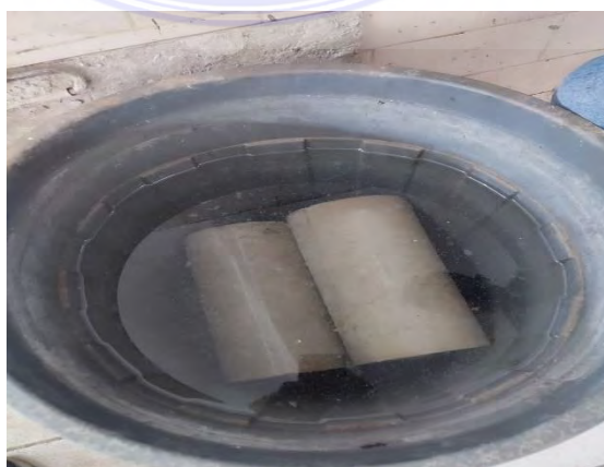
Gambar 24 Proses Perendaman Beton dengan Air Laut
