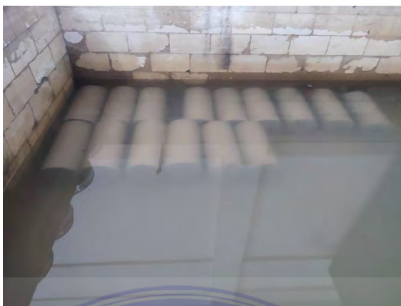
Gambar 22 Proses Perendaman Beton dengan Air Bersih
