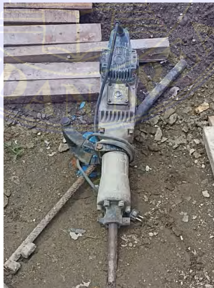
Gambar 3.1.3 Jack Hammer Sumber : Data Lapangan
