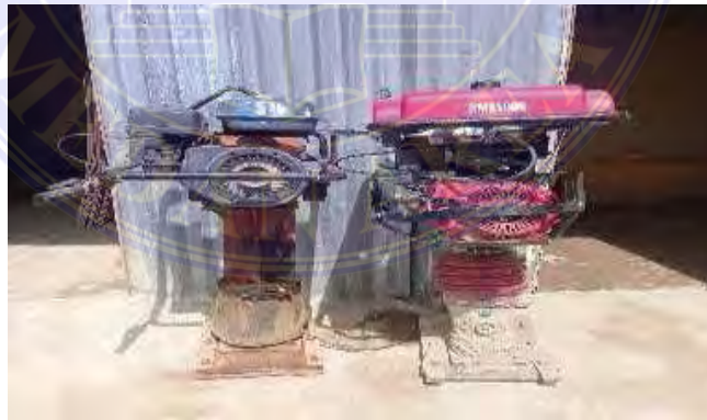
Gambar 3.1.5 Stamper Machine Sumber : Data Lapangan
