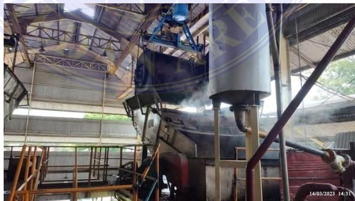
Gambar 3.28 Proses Pengangkatan Buah Rebusan
