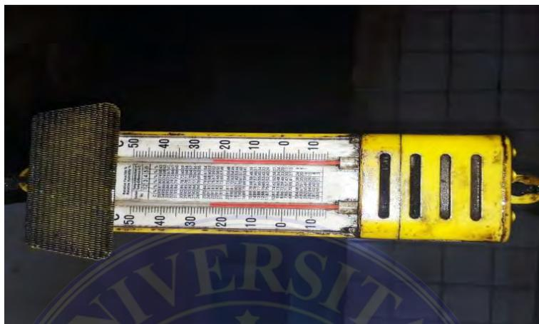
Gambar 3.28 Psikrometer
