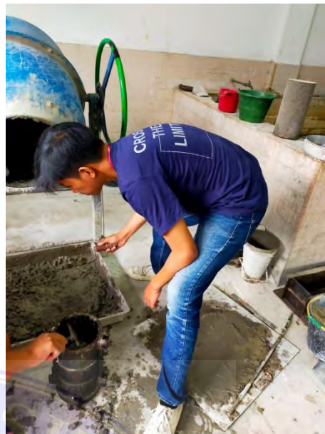
Campuran beton ke tabung silinder
