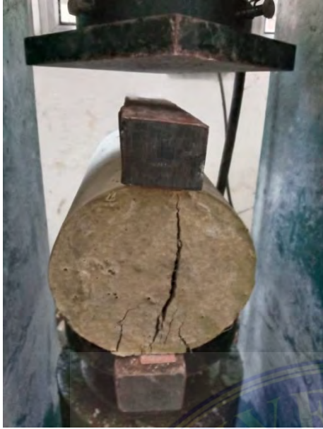
Uji kuat tarik belah Sumber: Dokumentasi lapangan, 2022
