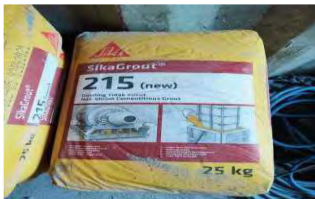
Gambar 3.2.8 Semen Grouting Sumber : Data Lapangan
