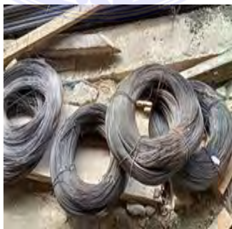
Gambar 3.34 Bendrat Sumber : Data Lapangan
