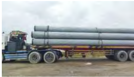
Gambar 4. 5 Truk Pembawa tiang pancang Sumber : Data Lapangan
