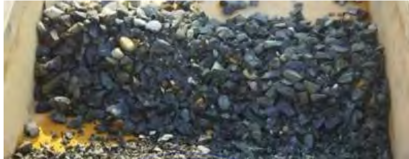
Gambar 3. 28 Agregat (Batu Pecah) Sumber : Data Lapangan
