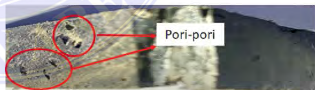
Gambar 6. Fenomena permukaan patah terhadap komposisi komposit karbon aktif pada 10 % berat.
