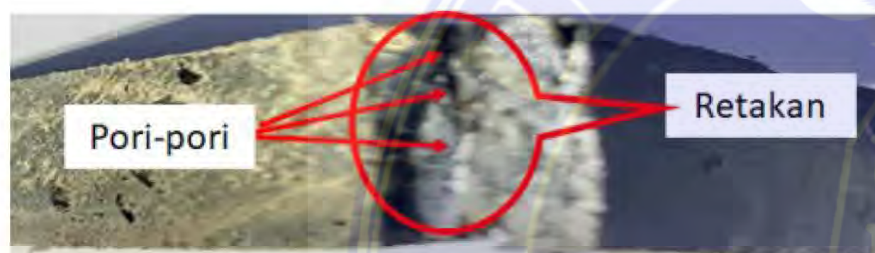
Gambar 7. Fenomena permukaan sampel terhadap komposisi komposit karbon aktif pada 10 % berat.
