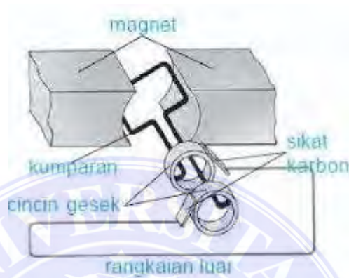
Gambar 2.9. Prinsip kerja generator
