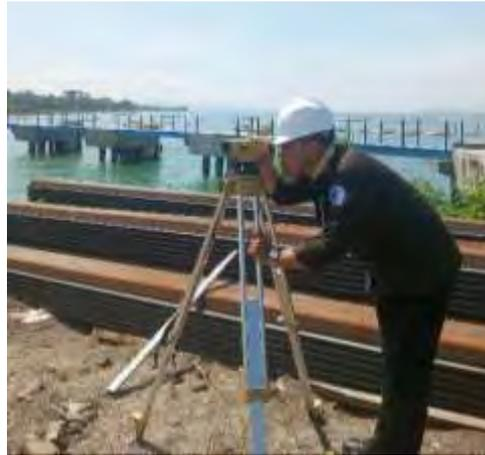
Gambar 3.4 *Total Station* Untuk Mengukur Jarak dan Membaca Sudut
