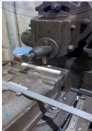
Gambar 3.18. Proses pembuatan takik pada bahan teflon
