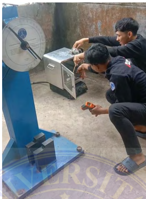
Gambar 3.25. Proses pemindahan spesimen ke dudukan alat uji
