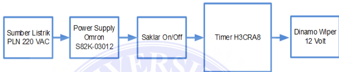
Gambar 3.6: Blok Diagram Sistem Pemotong Kacang Tanah Berbasis Timer H3CRA8
