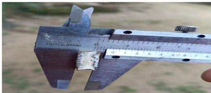
Gambar 3.19. Pengukuran bahan alumunium setelah ditempa
