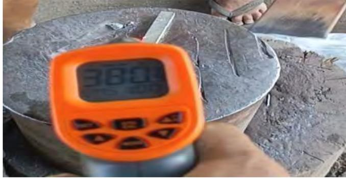
Gambar 3.17. Pengukuran suhu sebelum alumunium dipukul
