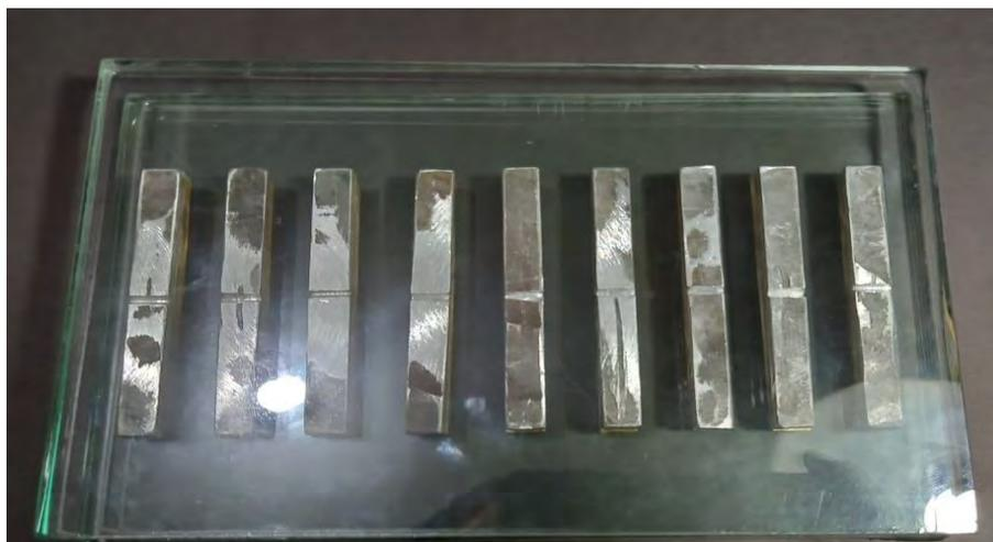
Gambar 3.24. Tampak atas spesimen yang sudah digabung tetapi belum diberi beban plat
