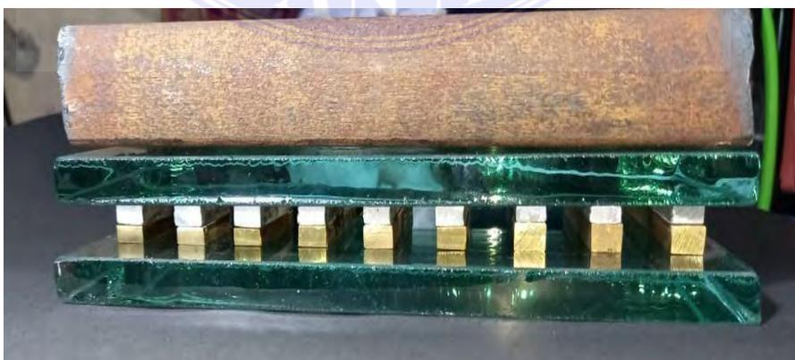
Gambar 3.26. Tampak samping spesimen yang diberi beban plat besi dengan berat 5 kg
