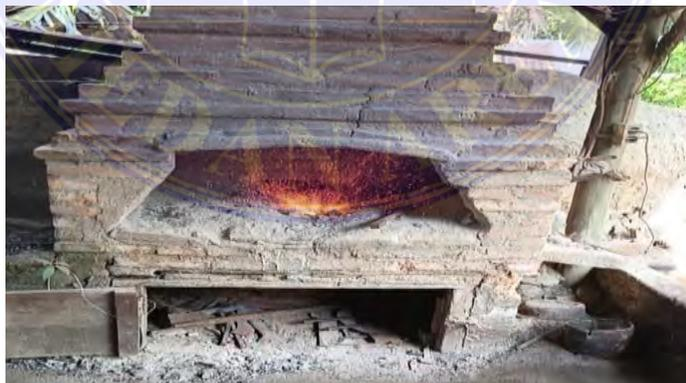
Gambar 3.16. Proses pemanasan bahan alumunium ditungku
