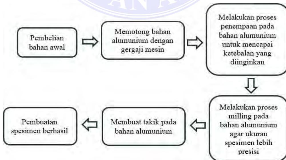
Gambar 3.14. Diagram alir pembuatan spesimen Alumunium
