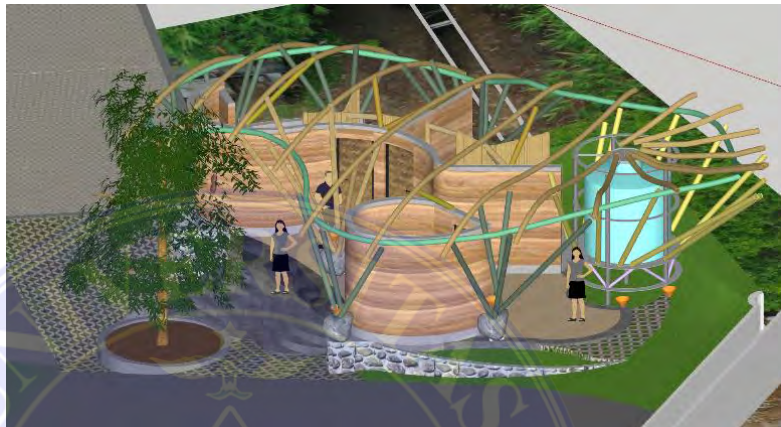
Gambar 3. 13 penerapan bambu pada rangka atap toilet
