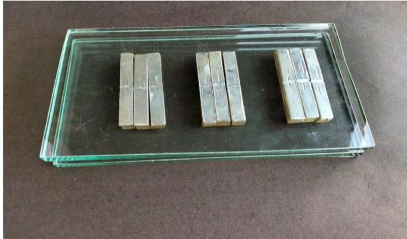
Gambar 3.15. Tampilan proses penggabungan spesimen Aluminium dan kuningan tanpa beban
