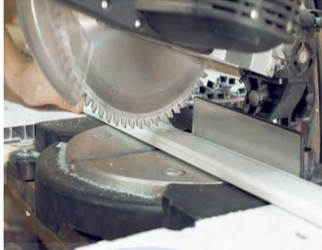
Gambar 3.9. Proses Pemotongan Bahan Aluminium
