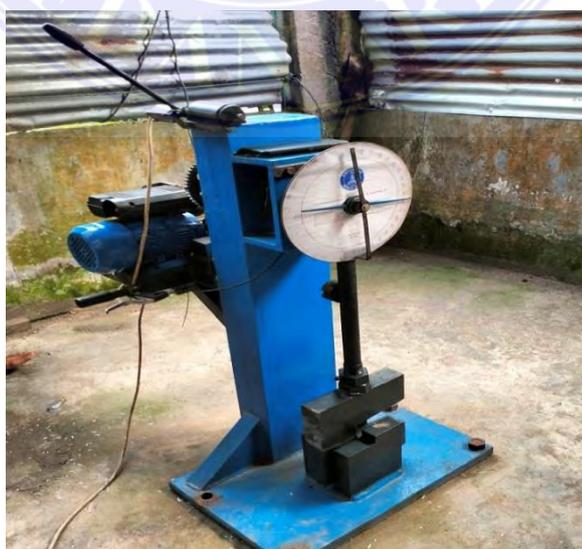
Gambar 3.3. Alat Uji Impak Metode *Charpy*
