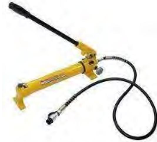
Gambar 2.8. Pompa hidrolik manual
