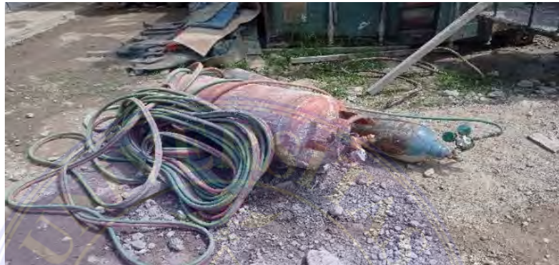
Gambar 3.27 Cutting Torch Sumber : Data Lapangan
