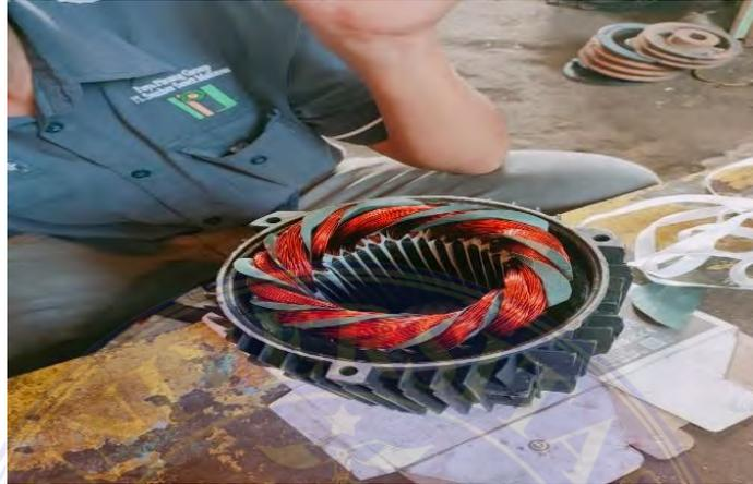
Gambar 3.18. Pemasangan Prespan Pembatas Antar Gulungan Tembaga
