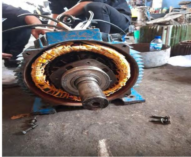
Gambar 3.21. Posisi Rotor Pada Stator
