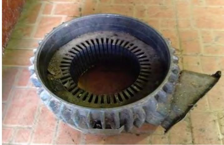
Gambar 3.13. Motor Setelah di Bongkar
