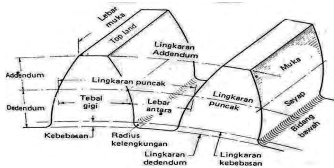
Gambar 2.1. Bagian Bagian Roda Gigi(Shigley, 2020)
