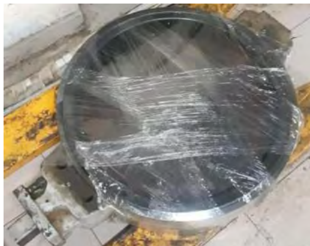
Gambar 2.23. Valve Dibungkus Menggunakan Wrap Food Grade (Muhammad Adam 2021)
