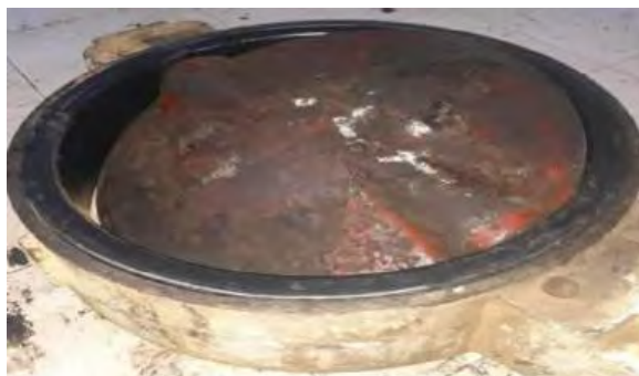
Gambar 2.22. Disc Dimasukkan Ke Dalam Valve (Muhammad Adam 2021)
