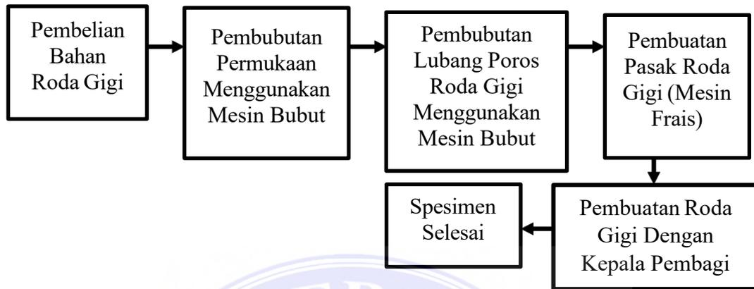
Gambar 3.12. Prosedur Pembuatan Roda Gigi
