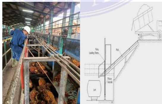
Gambar 3. 4(a) Loading Ramp, (b) Konstruksi buah yang sudah di sortir dimasukkan ke loading ramp.
