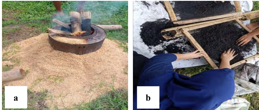
Gambar 1. Pembuatan Biochar Sekam Padi. a). Pembakaran sekam padi sehingga menjadi arang, b) Pengayakan Biochar sekam padi
