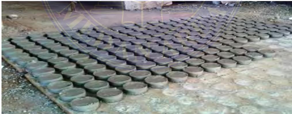
Gambar 4.4 Pembuatan beton decking,
