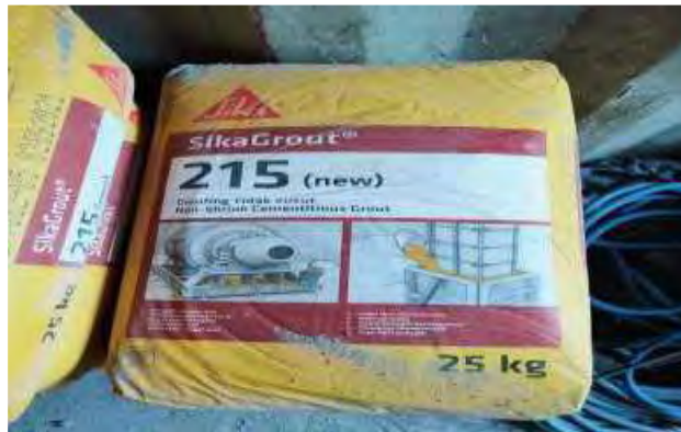
Gambar 3.2.8 Semen Grouting Sumber : Data Lapangan
