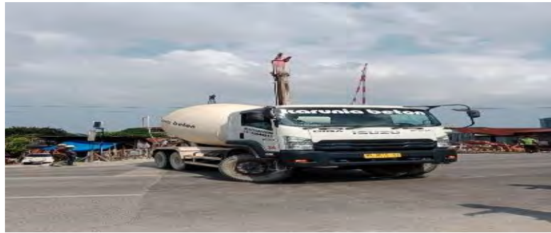
Gambar 2.1.6 Truck Mixer Beton Sumber : Data Lapangan
