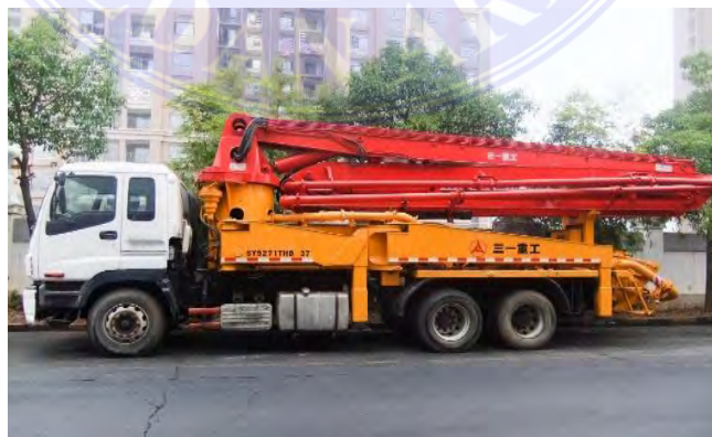
Gambar 2.1.11 concrete pump Sumber : Data Lapangan
