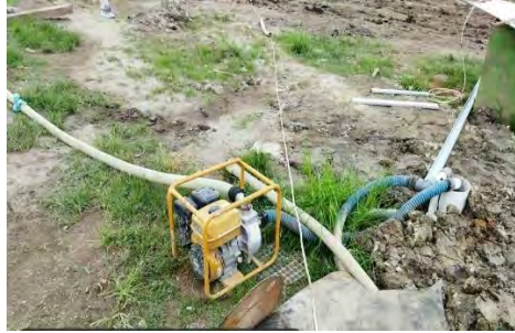
Gambar 3.16 Mesin Pompa Air
