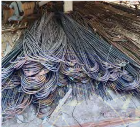
Gambar 3.34 Besi Tulangan Sumber : Data Lapangan
