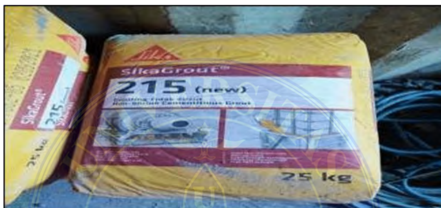
Gambar 3.39 Semen Grouting Sumber : Dokumentasi Lapangan
