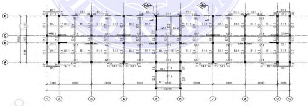
DENAH BALOK LANTAI 2
