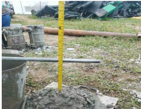
Gambar 4.2.12 Uji slump tes beton
