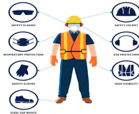
Gambar 4.1 APD (Alat Pelindung Diri) Sumber : Data Proyek
