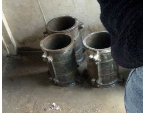
Gambar 3.27 Bekisting Silinder Sample Sumber : Dokumentasi Proyek, 2024
