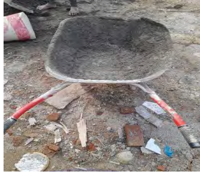
Gambar 3.13 Kereta Sorong Sumber : Dokumentasi Proyek, 2024
