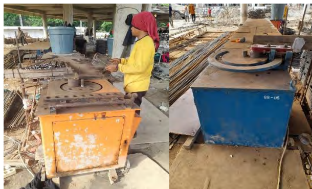
Gambar 3.15 Bar Bender Sumber : Dokumentasi Proyek, 2024
