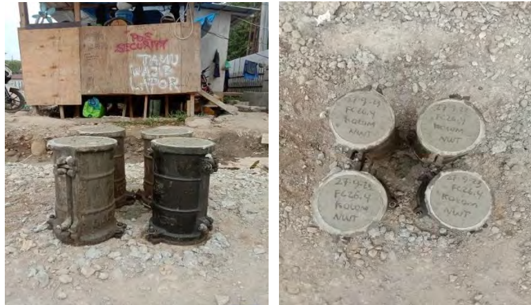
Gambar 4.9 Sample Silinder untuk uji kuat tekan beton Sumber : Dokumentasi Proyek, 2024
