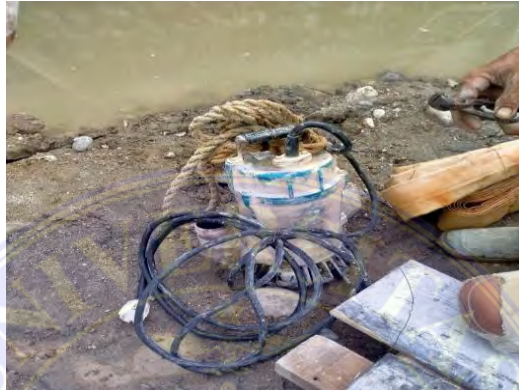
Gambar 3. 20 Pompa Celup Sumber : Data Lapangan
